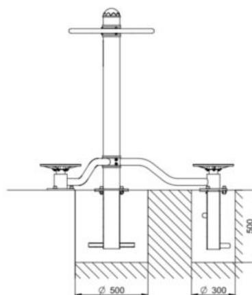
Je nach Untergrund besteht die Möglichkeit, das Outdoor Fitnessgerät auf dem Boden durch aufschrauben bzw. aufdübeln und unter dem Boden mit einem Betonfundament zu befestigen. Um die Geräte aufzuschrauben, muss ein fester, tragfähiger, ebener und in der Waage liegender Untergrund vorhanden sein.
