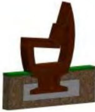
**Bodenanker Tisch:** Der Bodenanker (LxBxH: 650x100x300 mm) wird mit den Füßen verschraubt und ermöglicht das Eingraben oder Einbetonieren des Tisches. Sie erhalten 2 Bodenanker pro Tisch.
