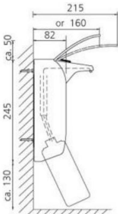
Zur Handdesinfektion wird der Hebel des Hygienespenders mit dem Ellbogen betätigt. Dadurch wird die Dosierpumpe des Desinfektionsmittels heruntergedrückt und ein abgemessener Hub Desinfektionsmittel ausgegeben.
